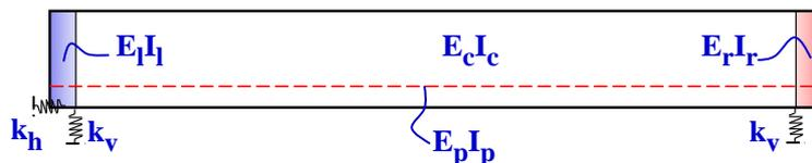
Fig. 4. Six model-update parameters for PSC beam
